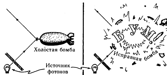
Рис. 5.1. Задача Элитцера — Вайдмана об испытании бомб. Сверхчувствительный детонатор бомбы срабатывает от соприкосновения с одним-единственным оптическим фотоном — может, впрочем, и не сработать, если его заклинит, в каком случае бомба считается холодной. Задача: найти гарантированно исправную бомбу при наличии большого количества бомб сомнительного качества.
