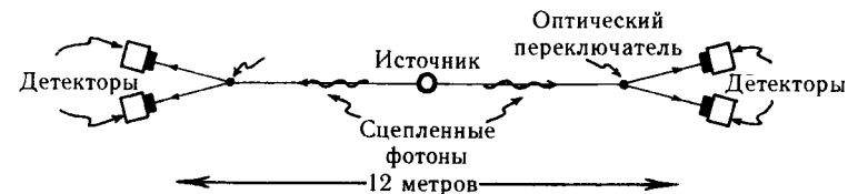
Рис. 5.6. ЭПР-эксперимент Алена Аспекта и его коллег. Пары фотонов в сцепленном состоянии испускаются из источника. Решение о том, с какой стороны от источника измерять поляризацию фотона, принимается уже после того, как фотоны устремляются в разных направлениях, — исключая возможность передачи «сообщения» об этом решении от одного фотона другому.
