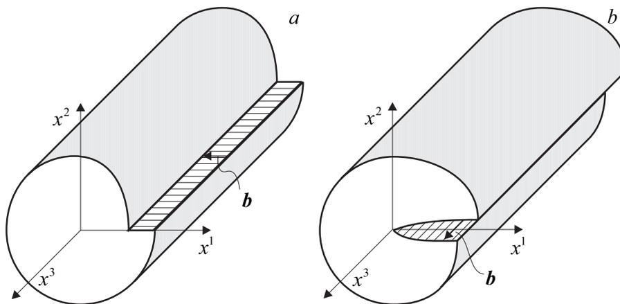
Рис. 36.2: Прямолинейные дислокации. (а) Краевая дислокация. Вектор Бюргерса  $\mathbf{b}$  перпендикулярен оси дислокации. (б) Винтовая дислокация. Вектор Бюргерса  $\mathbf{b}$  параллелен оси дислокации.
