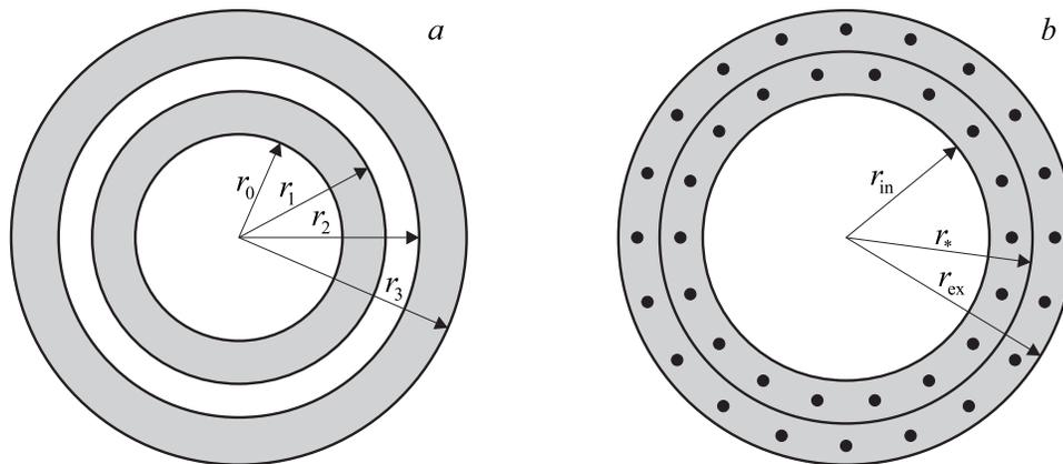
Рис. 36.30: Сечение двустенной трубки  $z = \text{const}$  до (a) и после (b) создания цилиндрической дислокации.
